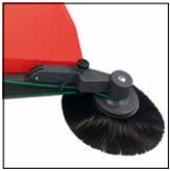
Verstellschraube für Seitenbesen
