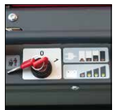
Batterie- und Onboard Ladegerät Anzeige inkl. Tiefentladeschutz
