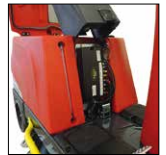
Integriertes Ladegerät und einfacher Zugang zur Elektronik
